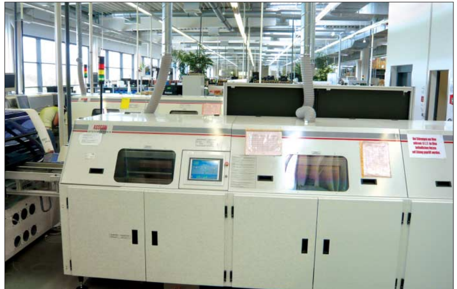
Bild 3: Inline-Dampfphasenlötanlage von Asscon
