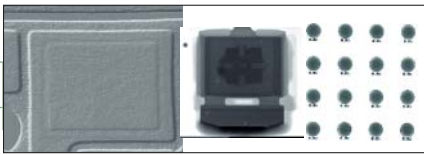
Bild 4: Lunkerfreier Leistungs-Chip, Leistungstransistor und BGA nach Lötung in einem Asscon-Dampfphasen-Vakuum-Lötsystem
