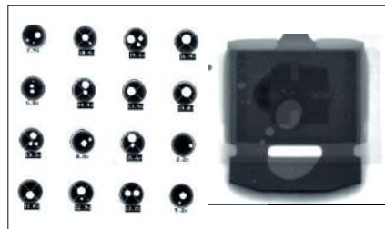
Bild 1: Röntgenaufnahme eines BGAs und eines Leistungstransistors mit mittlerer Lunkerrate (Macro Voids)
