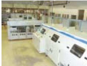
Bild 4: Zweite Inline-Dampfphasen-Lötanlage von Asscon mit vorgeschaltetem Bestückungsautomaten von Mimot
