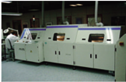
Bild 1: Vakuum Inline Dampfphasen-Lötanlage der 3. Generation von Asscon GmbH
